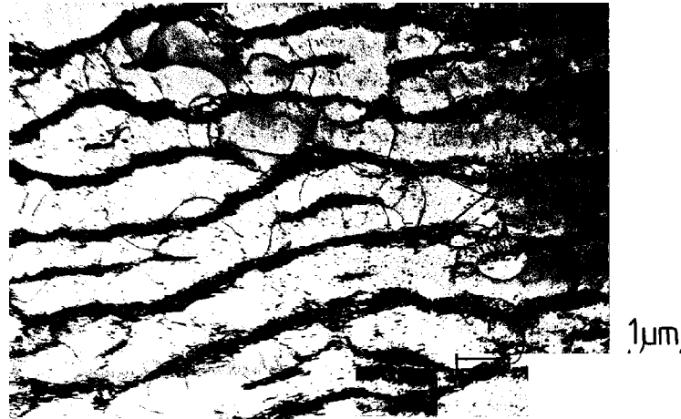
Abbildung 2.11: TEM-Aufnahme der Venen und Kanäle in der Matrixstruktur in einem bei Raumtemperatur ermüdeten Kupfereinkristall; Blick auf die Hauptgleitebene
