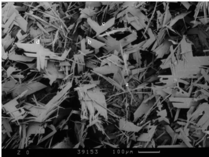
**Abb.7.1:** Gipskristalle, kristallisiert bei 68°C ohne Zugabe eines Additives
