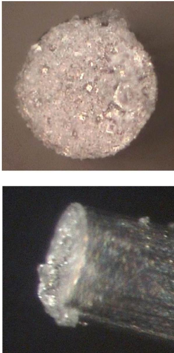
Abbildung 6.4: Mikroskopaufnahme eines  $250\ \mu\text{m}$  großen Wolframdrähtchens. An die Unterseite wurde ein Tropfen mit NaCl-Lösung angehängt und eingetrocknet.
