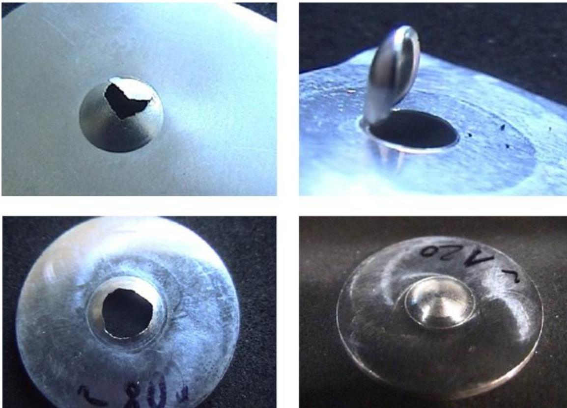
Abbildung 4.6: Ansicht der verschiedenen Folienmaterialien nach den Drucktests. Oben links (a): ebene Stahlfolie mit Riß von der Mitte ausgehend; oben rechts (b): ebene Probe aus F53 gefräst, mit „ausgestanztem“ Fenster; unten (c,d): Kugelkalotte, aus F53 herausgefräst mit eher mittigem Riß (c).
