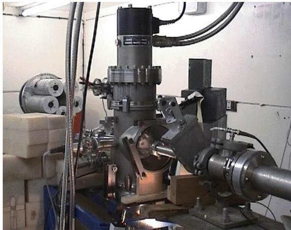
Abbildung B.2: Experimentaufbau: der Kaltkopf, die Strommessung und der Plexiglasflansch mit dem Target
