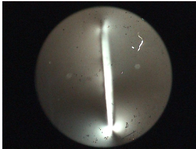
Abbildung 6.8: Bestrahlte \text{SiO}_2 -Probe, im Lichtmikroskop mit gekreuzten Polarisationsfiltern fotografiert. Der bestrahlte Streifen ist im Gegensatz zur Umgebung nicht mehr optisch isotrop.
