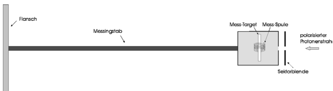
Abbildung 17: Schematische Darstellung des Probenträgers
