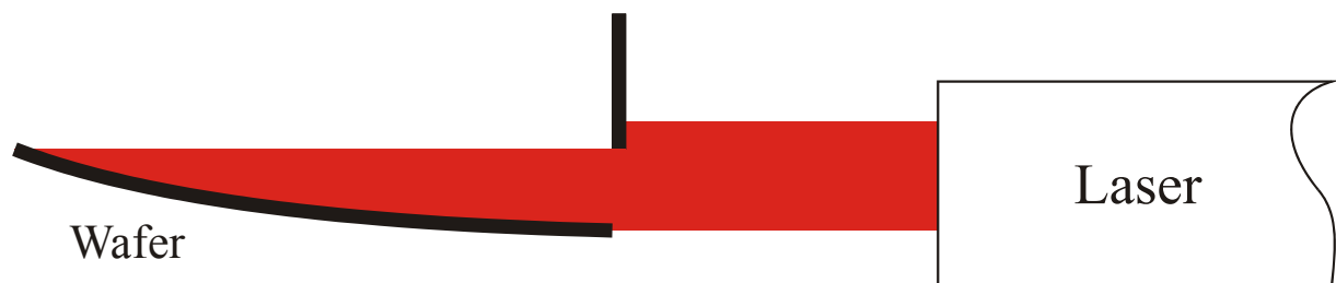
Abbildung 23: Begrenzung des Laserstrahls auf die gewünschte Dicke; der reflektierte Anteil wurde nicht mit eingezeichnet
