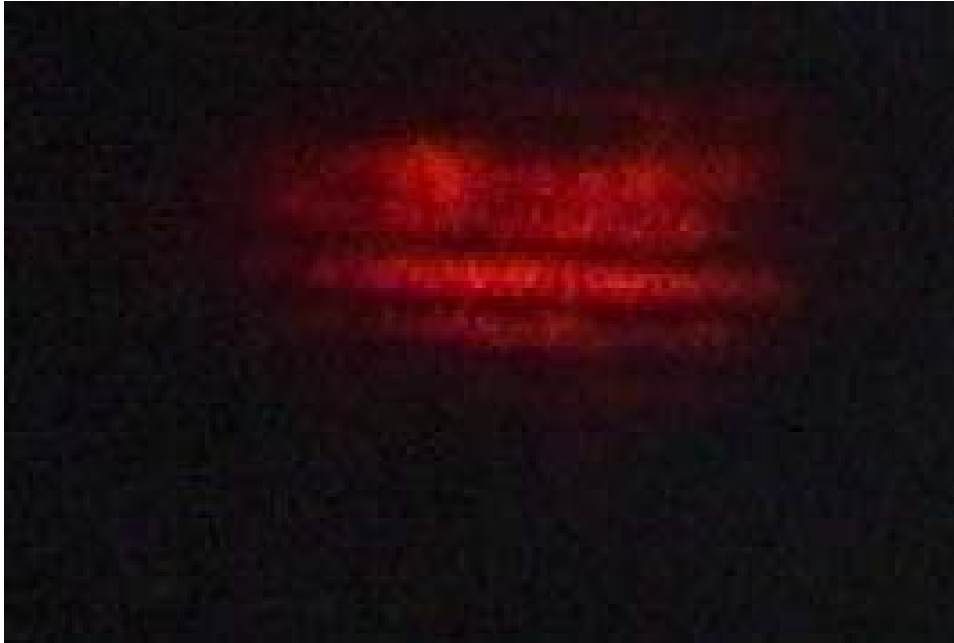
Abbildung 26: reflektierter Laser bei vollständig ausgedehntem Piezo-Nr.7. Die anderen Piezo-Stellelemente hatten die gleiche Ausdehnung wie in Abb. 25
