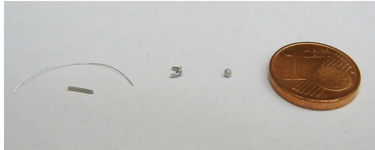
Abbildung 3.1: v.l.n.r: Co und Pd Drahtstücke mit 0,5 bzw. 0,125mm Durchmesser, fertig gewickelte Probe, daneben aufgeschmolzen Probe im Grössenvergleich mit 1 Cent Stück
