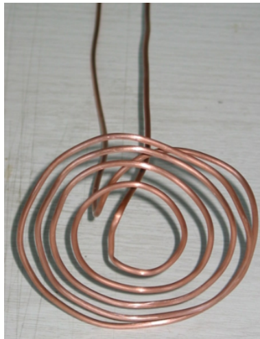
Abbildung 3.8: Zur schnelleren Druckreduzierung im oberen Rezipienten dient eine Kühlfalle, die aus einer Kupfer-Kapillare besteht und von flüssigem Stickstoff durchflossen wird.
