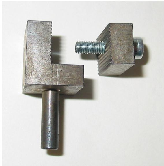
Abbildung 5.5: *Die dritte Form der Haltebacken.* Sie Schraube dient hier zur Zentrierung und zum Festklemmen der Probe. Die Sägezahnstruktur der Innenseiten garantiert ein Festhalten bei beiden Belastungsrichtungen. Durch die verbreiterte Probenform werden Drehbewegungen der Probe beim Festspannen minimiert.
