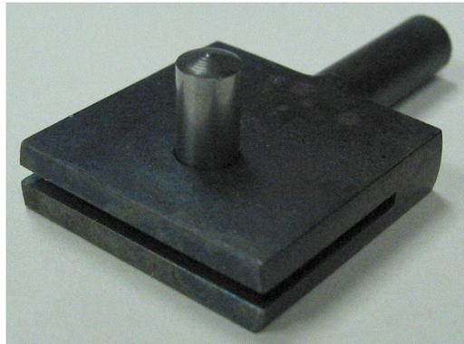
Abbildung 5.4: *Die zweite Form der Haltebacken.* Der Stift dient zur Zentrierung und verschwindet vollständig in der Haltebacke. Die Breite des Schlitzes wird an die Probendicke angepasst.
