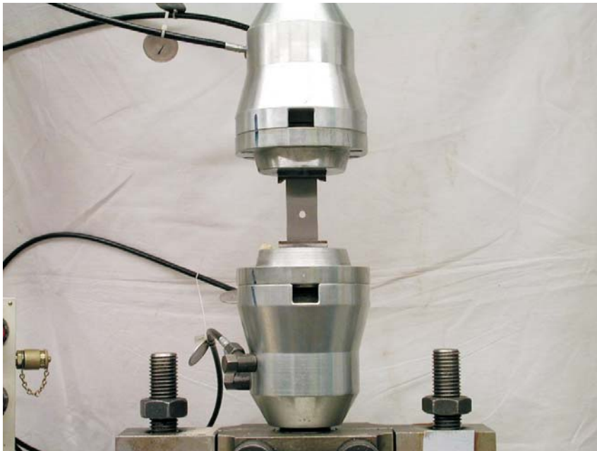
Abbildung 5.3: Probeneinspannung in der hydraulisch arbeitenden Wechsellagerungsapparatur am Fraunhofer Institut LBF, Darmstadt.
