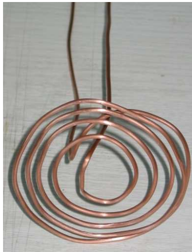
Abbildung 3.13: Die Kupferkapillare wird von flüssigem Stickstoff durchspült und dadurch gekühlt. Dadurch erreicht man innerhalb von 30 Minuten ein für eine Messung ausreichend gutes Vakuum. Ohne die Spirale dauert dies ca. 2 Stunden [Hoe04].
