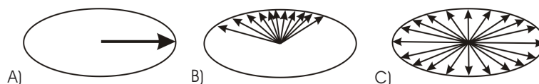
Abbildung 2.4: [5] Einfluss der Feldinhomogenitäten auf die Phasenkohärenz nach einem 90^\circ -Puls. (A) Nach dem 90^\circ -Puls präzedieren alle Spins, die einen Beitrag zur Magnetisierung leisten, in Phase. (B) Durch die Feldinhomogenitäten präzedieren die Spins unterschiedlich schnell und es kommt zu einer Auffächerung. (C) Die Kohärenz geht durch diese zunehmende Auffächerung letztlich komplett verloren. Die Magnetisierung hat jetzt keine Komponente mehr in der x-y-Ebene.
