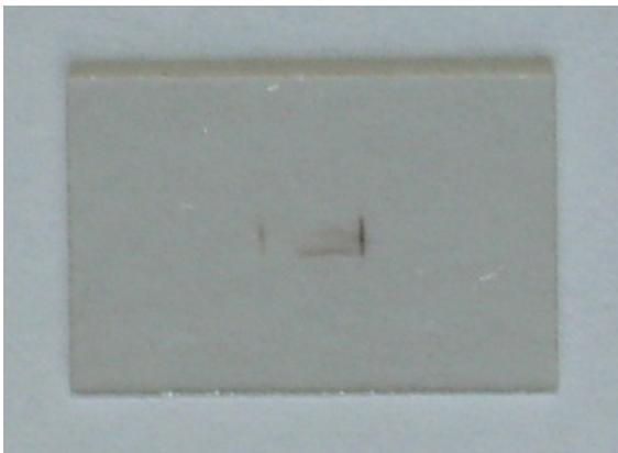
Abbildung 5.5: *Durch die Tantalblende mit  $0\text{...}15\ \mu\text{m}$  Schlitzbreite bestrahlter Kristall: Der bestrahlte Bereich ist braun verfärbt, wobei der mittlere Abschnitt das eigentliche Gitter darstellt, während die vertikalen Streifen links und rechts durch eine Bestrahlung durch die Spalte neben dem Schlitz entstanden sind.*
