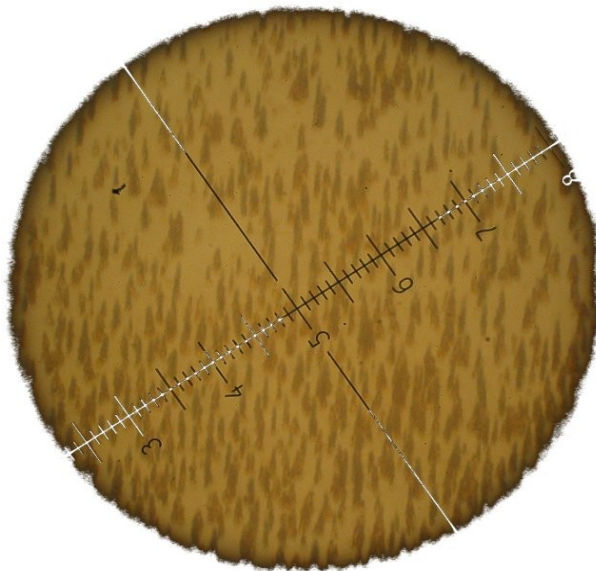
Abb. 4.9.: Nadelbildung bei der Sedimentation im Feld eines einzelnen Magneten. 1Skt. entspricht 5\mu\text{m} . Die Partikel haben einen Durchmesser von 1\mu\text{m} .
