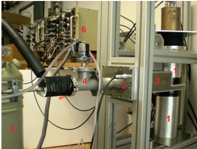
Abbildung 5.11: Versuchsaufbau zur Messung der Positronenlebensdauer mit eingebauter Probenumgebung. Man erkennt die Detektoren (1), die Kombination aus Vakuumpappe und Probenumgebung (2), die Elektrodurchführung (3) sowie die isolierten „kalten Hosen“ (4). Der Stickstoff-Dewar (5) und die verwendete Elektronik (6) sind am Bildrand dargestellt.
