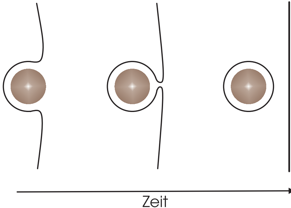
Abbildung 2.6: Bei dem Orowan-Prozess umgeht eine Versetzung (hier von links einlaufend) eine Ausscheidung und hinterlässt dabei einen Versetzungsring um die passierte Ausscheidung. Die schwarze Linie symbolisiert hier die Versetzungslinie.
