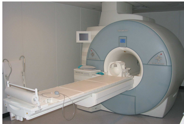
Abbildung 2: Dies ist der Tomograph bei Life & Brain, der für die Messungen verwendet wurde. Längs der Liege im blauen Hohlzylinder verläuft das \vec{B}_0 - Feld. Noch vor dem Hohlzylinder ist die Kopfspule zu sehen, die für die Messungen das B_1 - Feld liefert.
