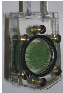
Abbildung 4.6: Bei dem \gamma -Knochen ist die Spongiosaschicht durch eine 1cm dicke Plexiglasplatte simuliert, in die ein Raster aus feinen Bohrungen eingebracht ist, die beiden Kompaktaschichten werden wieder durch 1mm dicke Plexiglasplatten nachgeahmt.
