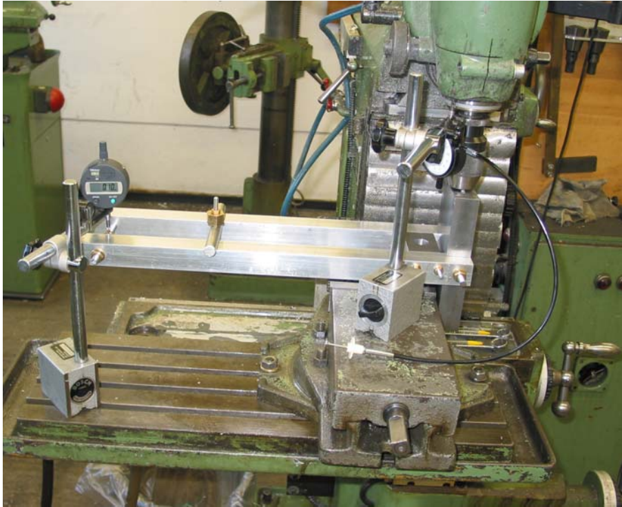
Abbildung 3.6: Aufbau zur Messung der Hebelverstärkung: Links und rechts sind die Wegmesser zu erkennen. Eine geringe Auslenkung aus der Waagerechten durch Verstellen des Frästisches führt zu einer (verstärkten) Auslenkung auf der linken Seite.
