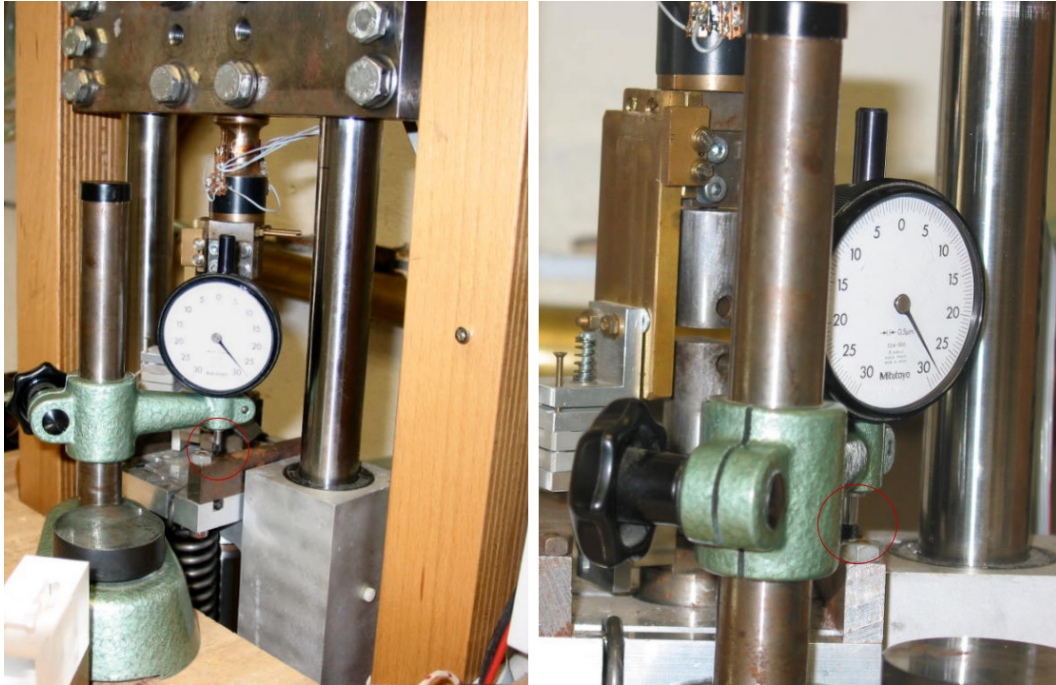
Abbildung 3.12: Wegmessung: Innerhalb des roten Kreises ist der Messfinger des Wegmessgerätes zu sehen, der auf dem unteren (beweglichen) Teil der Wechselverformungsmaschine ruht und seine Bewegung verfolgt.
