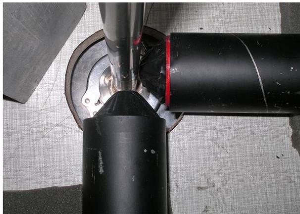
Abbildung 5.6: Das Foto zeigt die beiden Detektoren. Sie bilden einen rechten Winkel, damit keine rückgestreuten Annihilationsquanten detektiert werden. Der Kryostat wurde derart erhöht, dass sich die Probe auf gleicher Höhe mit den Detektoren befand.
