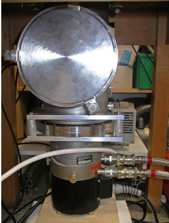
Abbildung 5.2: Der Kaltkopf wurde mit einem Isolierkessel umgeben und zur weiteren Isolierung und dem Entziehen der Feuchtigkeit (verhindert die Vereisung der einzelnen Bauteile) ein Vakuum von  $\approx 10^{-5}$  mbar mit einer Vorvakuumpumpe und einer Turbopumpe erzeugt. Diese wurden auf der auf dem Foto abgewandten Seite des Kessels angebracht, an der sich ebenfalls die Elektrodurchführung für die Spannungsversorgung des Leistungswiderstandes befand.
