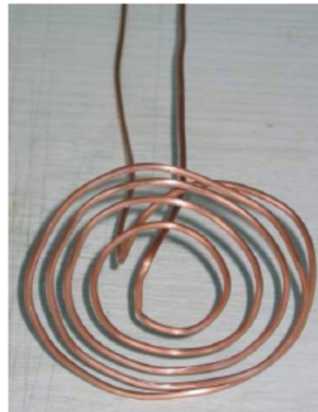
Abbildung 3.14: Die Kühlspirale besteht aus Kupfer und wird von flüssigem Stickstoff durchflossen. Der Endwert des Vakuums wird dadurch schneller erreicht und zusätzlich verbessert [Hoe04].
