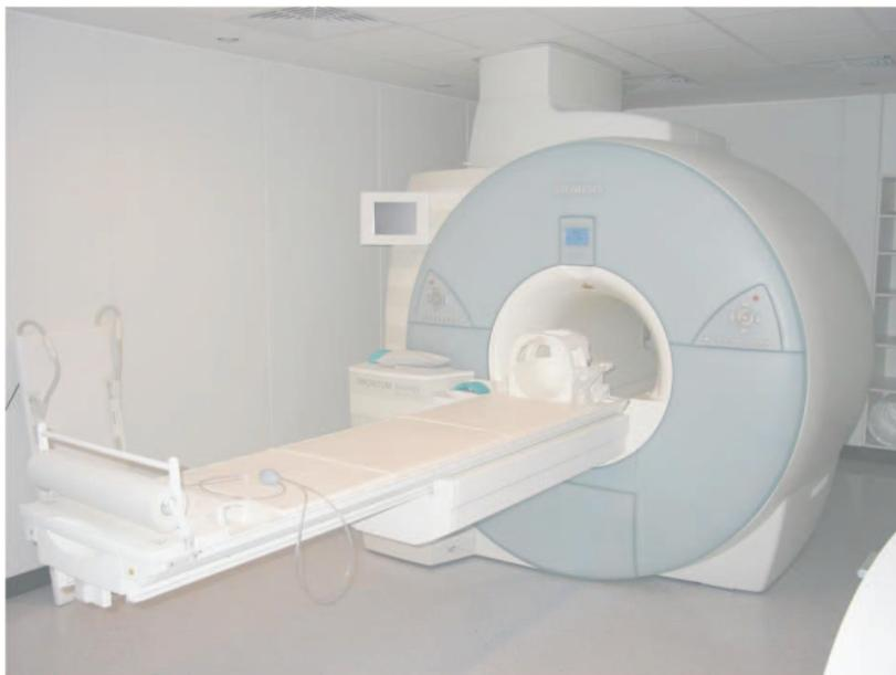
Abbildung 2.5 – Siemens MAGNETOM Avanto 1,5T Tomograph am Forschungszentrum Life & Brain
