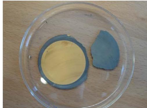
Er wurde mit 100 nm Chrom als Haftvermittler und mit 1000 nm Gold bedampft. An einem Impedanzanalysator konnte gezeigt werden, dass die Kontaktierung funktionierte und mit diesem Verfahren auch weitere Emitter elektrisch kontaktiert werden können.
