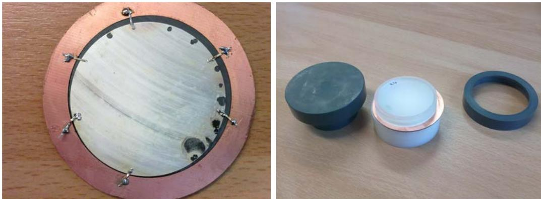
**Abbildung 2.8** – Auf dem linken Bild ist der Emitter zu sehen, nachdem er in die Platine geklebt und zur Kupferplatte kontaktiert worden war. Die Punkte auf dem Emitter zeugen von Schwierigkeiten bei dem Versuch, auf der Silberschicht zu löten.
