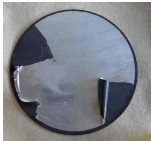
Die inneren Spannungen waren größer als die Haftung wodurch sich das Silber ablöste. Der Grund warum die ursprüngliche Dicke 1000 nm betragen sollte hing mit der elektrischen
