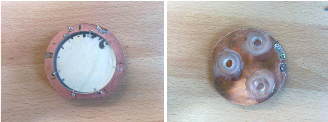
Abbildung 2.11 – Links ist die Vorderseite und rechts die Rückseite des fertiggestellten Emitters zu sehen.
