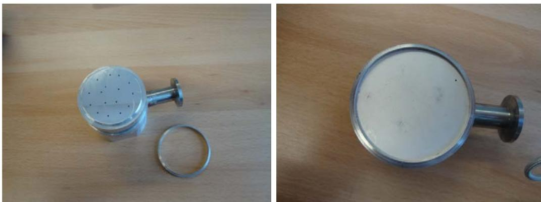
**Abbildung 2.2** – Das linke Bild zeigt die Aufnahme auf die der Ultraschallemitter mittels Vakuum gesaugt wurde. Rechts neben der Aufnahme liegt der Fixiering. Auf dem rechten Bild liegt der Ultraschallemitter auf der Aufnahme und wird mittels des Fixierring fixiert. Über den Stutzen kann eine Vakuumpumpe angeschlossen werden.
