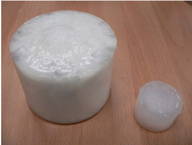
Abbildung 3.6: PVA-Phantome. Links großes Phantom \gamma aus ca. 500 ml PVA-Lösung hergestellt, rechts kleines Phantom \delta_3 aus 50 ml PVA-Lösung.
