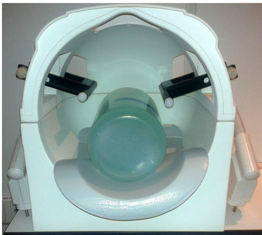
**Abbildung 3.3:** Phasennormale in der Kopfspule. PVC-Rohre mit Phasennormalen sind in eine U-förmige Halterung geklemmt. Diese kann an der Spule festgeklemmt und in beliebige, kopfnahen Positionen gebracht werden. Bei den Messungen ist der Kopf in etwa auf der Position, auf der sich die eingelegte Flasche befindet.
